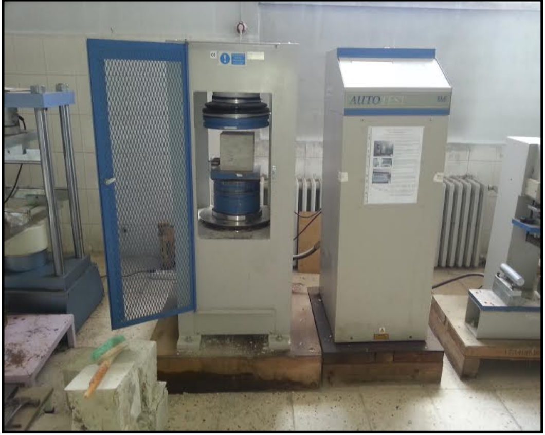
Şekil 3.11. Beton presi ve deney anından bir görünüm
