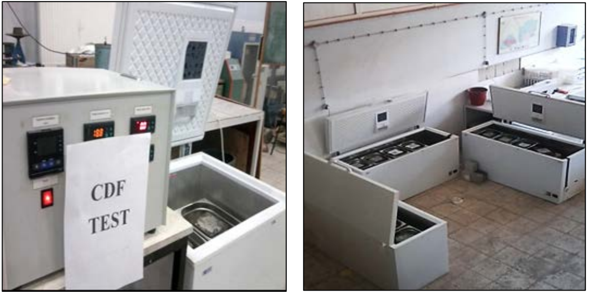
Şekil 3.14. CDF Yöntemi'ne göre oluşturulan donma-çözülme deney düzeneği
