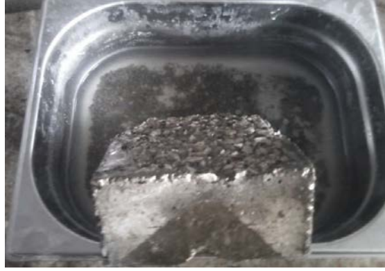
Şekil 3.17. Donma çözülme çevrimlerinden sonra numunelerden kopan parçalar
