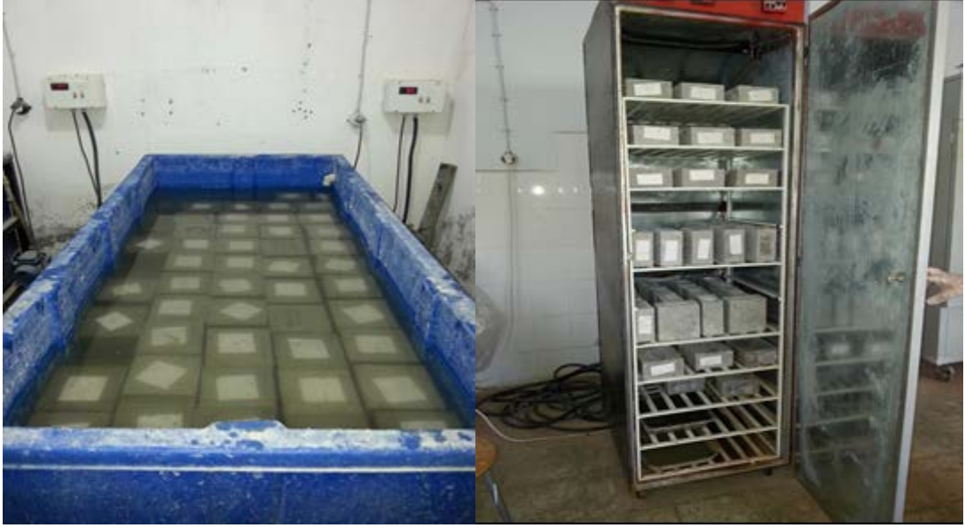
Şekil 3.8. Kür havuzu ve iklim kontrollü kabin (sağda)
