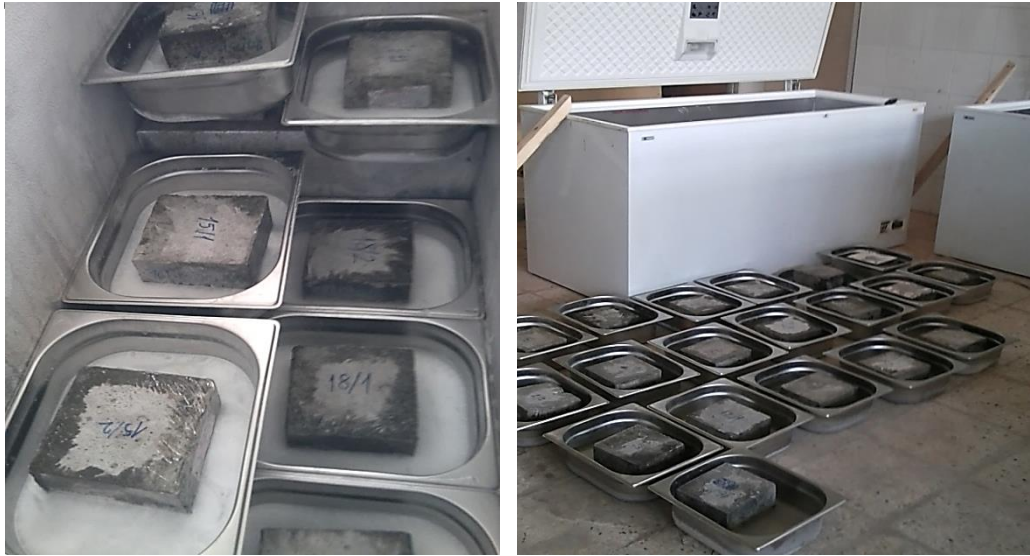
Şekil 3.16. Numunelerin dondurulma (a) ve çözdürülme (b) işlemleri
