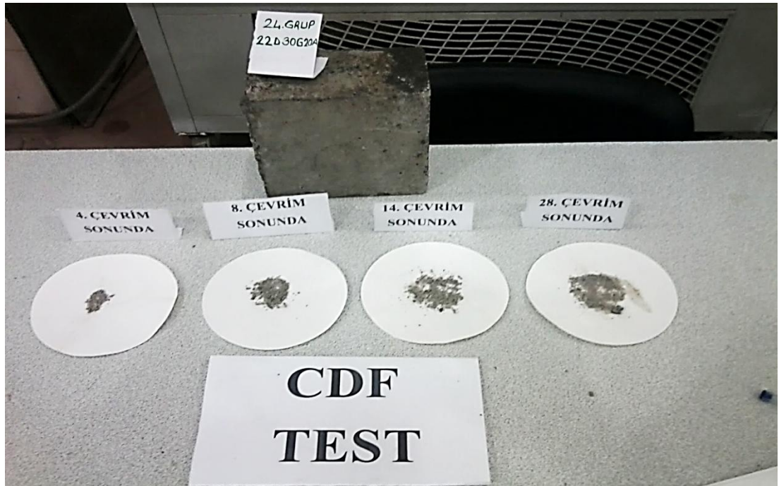
Şekil 3.19. En çok kabuk atan karışım (16D0G6A) (a) ile en az kabuk atan karışımın (22D30G20A) (b) kabuk atmalarının karşılaştırılması
