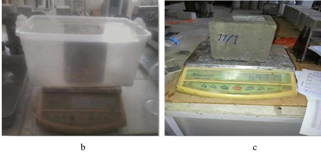
Şekil 3.9. Numunelerin etüvde kurutulması (a), suda (b) ve havada(c) tartılması
