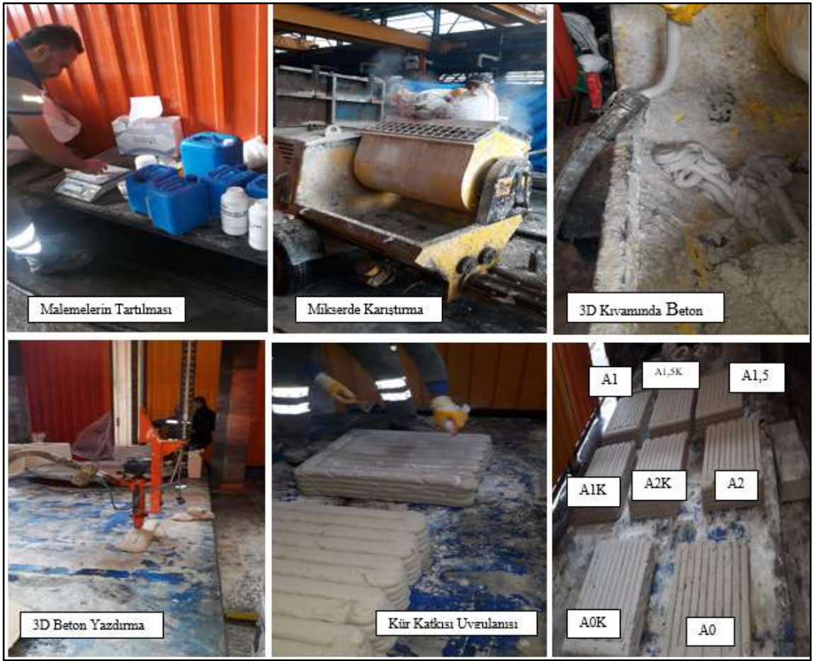
Şekil 45. 3D beton üretim sürecinin aşamaları
