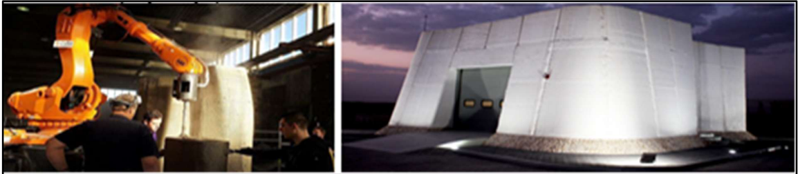
Şekil 10. CyBe firmasına ait mobil 3D Printer cihazı ve firma tarafından yapılan 3D Dubai Ar-Ge Laboratuvarı (Anonymous 2020d)
