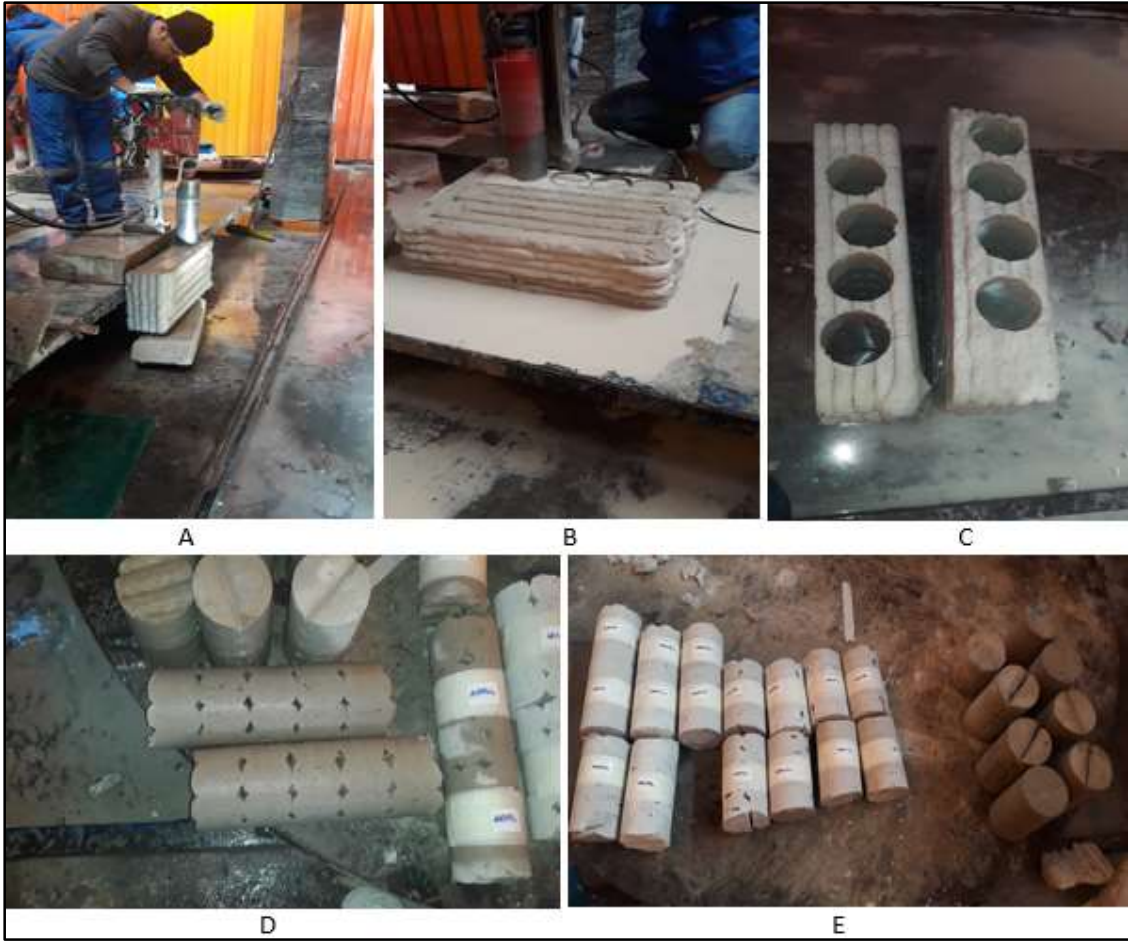
Şekil 48. Karot alım süreci (A: Döküm yönüne göre yatay yönde karot alınması, B: Dikey yönde karot alınması, C: Karot alındıktan sonra geriye kalan beton kısım, D: yatay yönde alınan ve E: Dikey yönde alınan karot numunelerinden örnekler)
