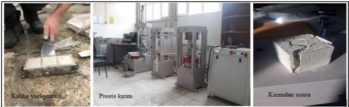
Şekil 43. Ön deneyler esnasında üretilen 3D beton numunelerin basınç deneyi
