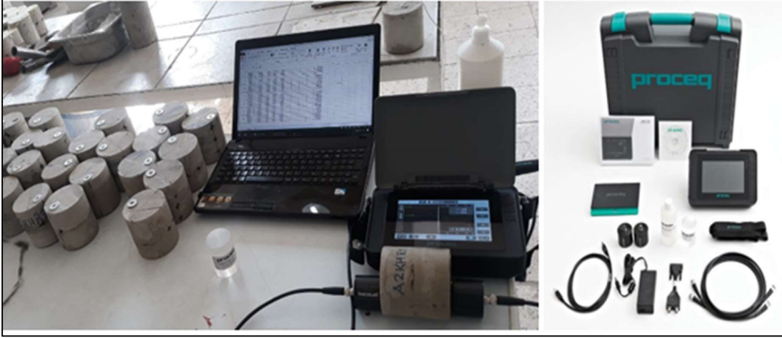
Şekil 51. UPV cihazı, aparatları ve deney esnasından bir görüntü
