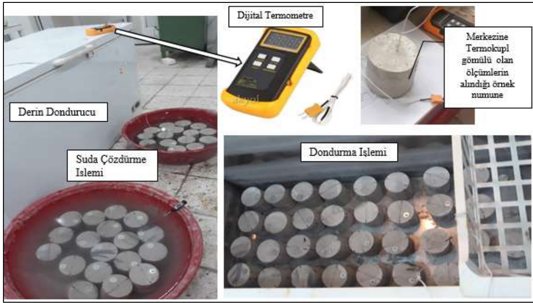
Şekil 53. ASTM C 666'ya göre yapılan donma-çözülme deneyi, dondurucu ortam ve dijital termometre
