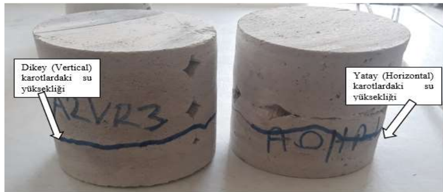
Şekil 65. Kılcal su emme deneyinde 24 saat sonunda numunelerde oluşan su yükseklikleri
