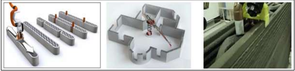
Şekil 3. CC nozul ucu, bir CC cihazı konfigürasyonu ve çimentolu malzemelerle yapılan baskı işlemi (Khorranshahi and Mokhtari 2017; Ghaffar et al. 2018)
