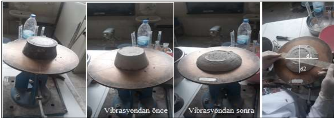
Şekil 41. Yayılma tablası deneyi
