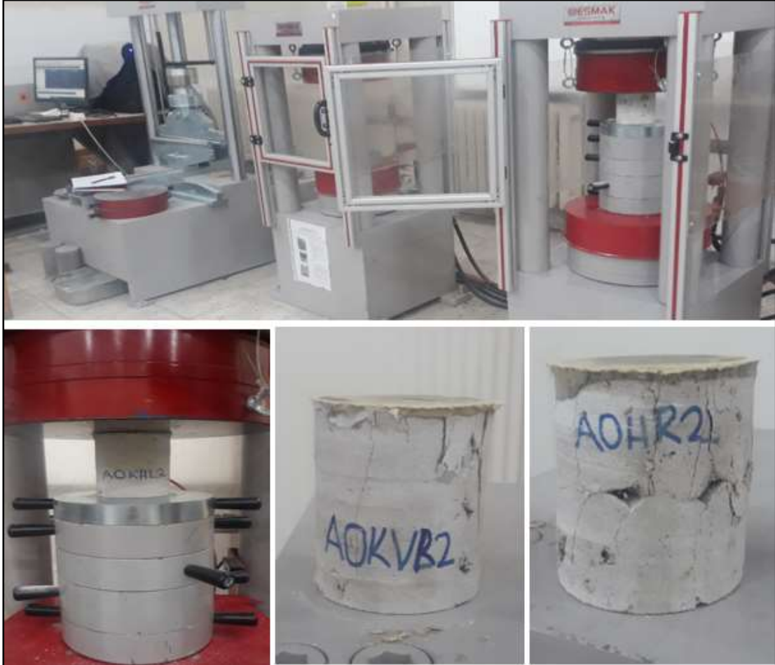
Şekil 50. Basınç dayanımı deneyi ve deneyden sonraki kırılma şekilleri
