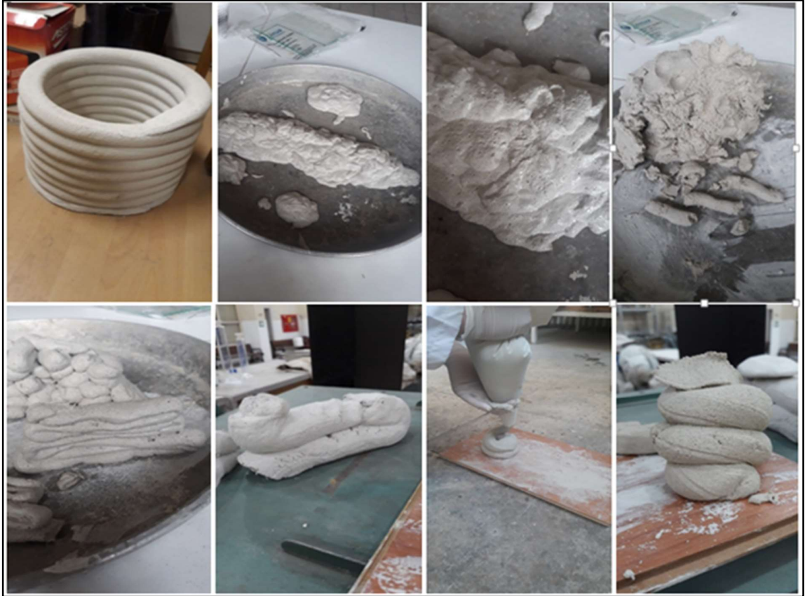
Şekil 38. Ön deneylerden görüntüler (sol üstteki İSTON’da üretilen 3D beton saksı örneği, diğerleri Atatürk Üniversitesi’ndeki denemelerden görüntüler)
