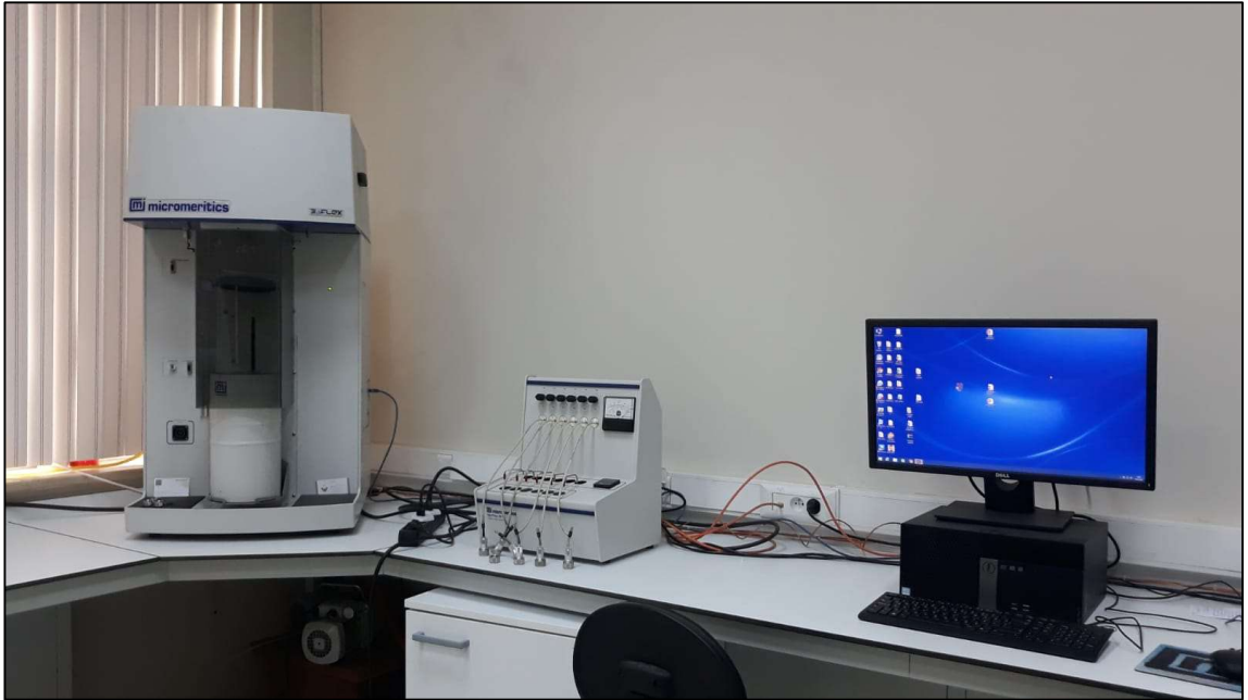
Şekil 55. BET analizi için kullanılan Micromeritics 3Flex Version 5.00 marka cihaz.
