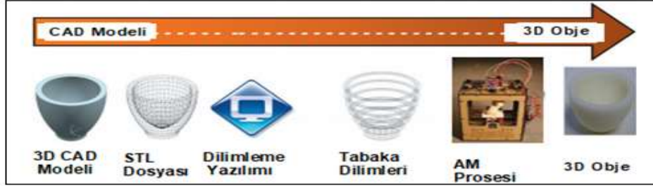
Şekil 2. AM yönteminde bilgisayardaki tasarımdan objenin oluşumuna kadar geçirilen evreler (Campbell et al. 2011)
