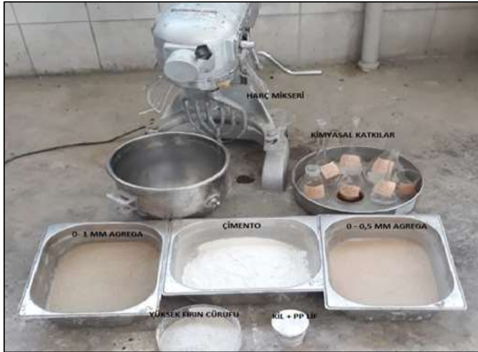
Şekil 37. 3D beton üretiminde kullanılan malzemeler ve harç mikseri
