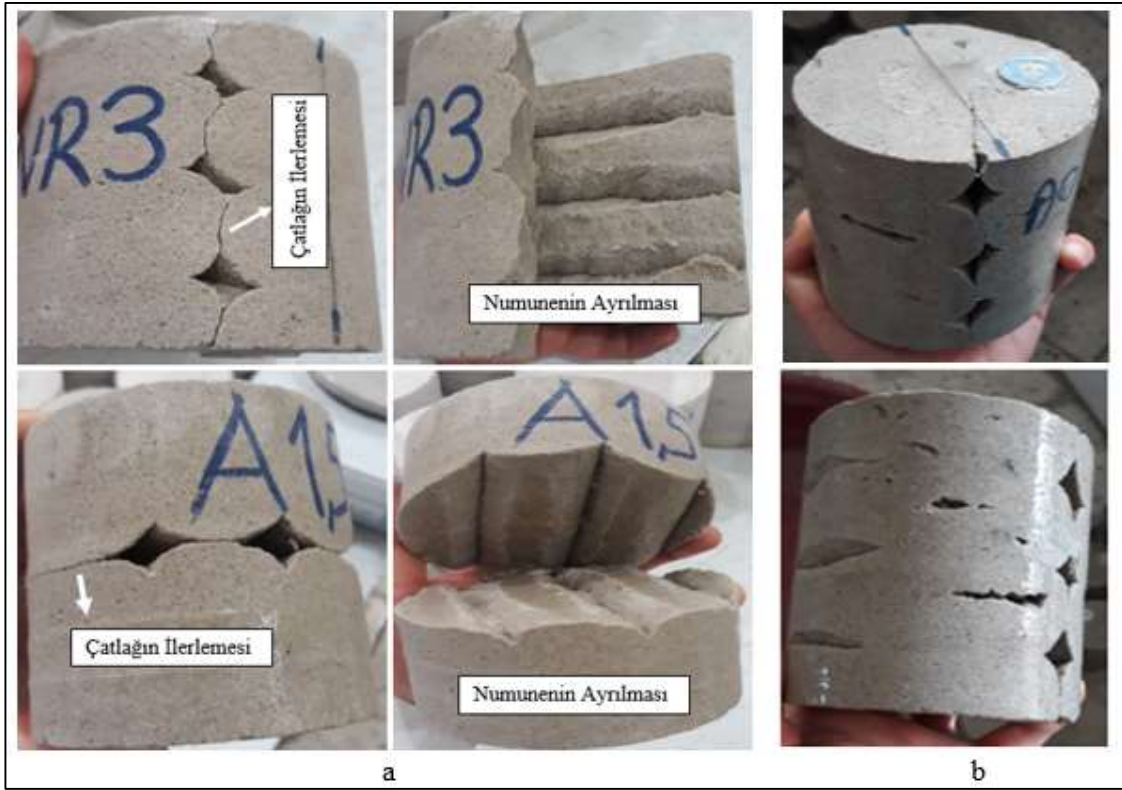
Şekil 75. a: Donma-çözülme uygulanan 3D beton numunelerde hasar oluşumu ve numunelerin kırılması, b: Numunelerde bulunan çeşitli boyutlardaki boşluklar
