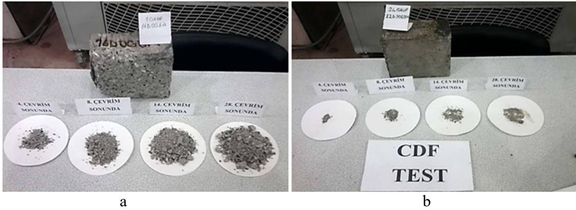
Şekil 2. Donma-çözülme sonrası en çok kabuk atan karışım (16D0G6A) (a) ve en az kabuk atan karışım (22D30G20A) (b).
